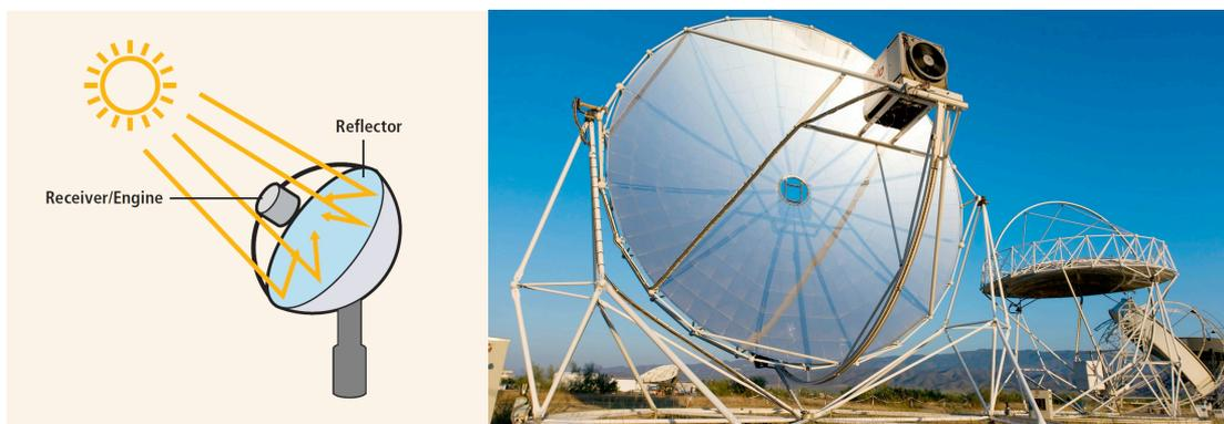
Abb. 10: Links: Funktionsweise einer Dish-Sterling-Anlage (IPCC 2012: 356), Rechts: Realisierte Anlage (DLR 2012: o.S.)
