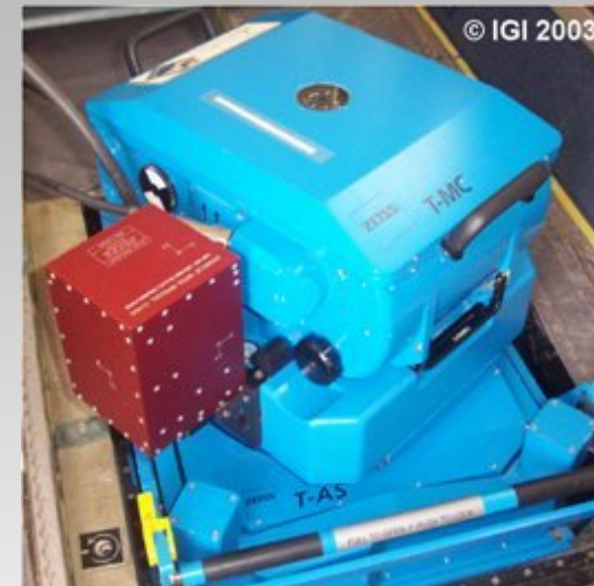
AEROcontrol Systeminstallation befestigt an RMK-TOP Kamera
